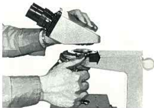
Abb. 3 Aufsetzen des Binokulartubus S auf das Mikroskop
