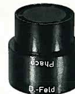
Abb. 13 Einsteckbare Blende für Dunkelfeld und Phasenkontrast zum fest montierten Kondensor
