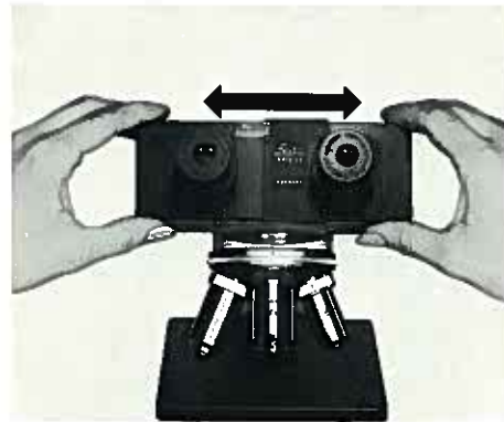
Abb. 8 Einstellen des Augenabstandes am Binokulartubus S
