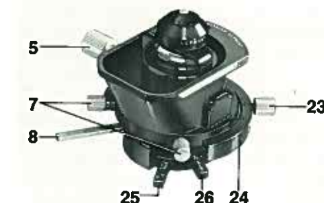
Abb. 20 Achromatischer Klappkondensor Nr. 601 mit angelegtem Halter für Polarisator und Kompensator
