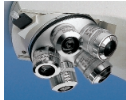
5-fach Objektivrevolver für Hell-Dunkelfeld
