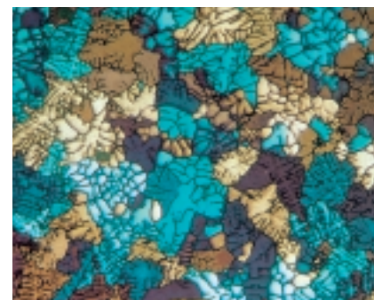
Aluminium-Legierung Barker-Ätzung, Pol-Kontrast
