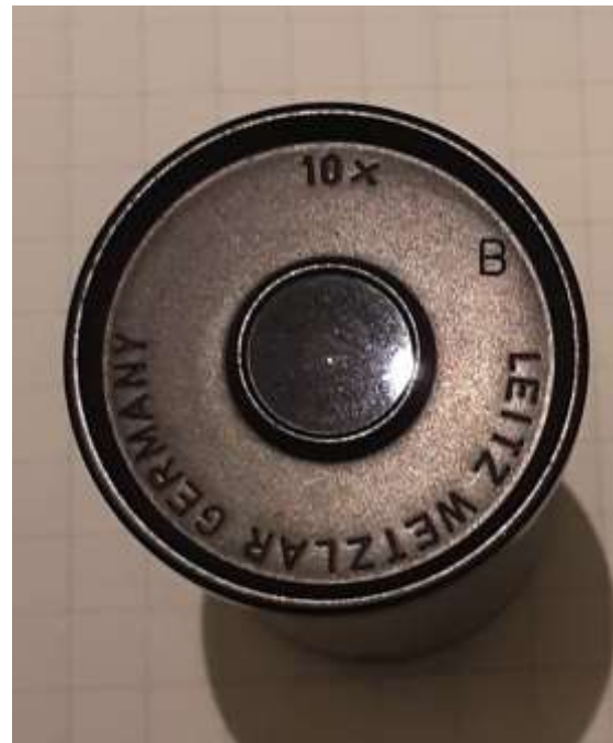
Variante 2: Beschriftung: 10x B / Leitz Wetzlar GERMANY Höhe 34mm / Durchmesser 23mm / Keine Beschriftung am Mantel
