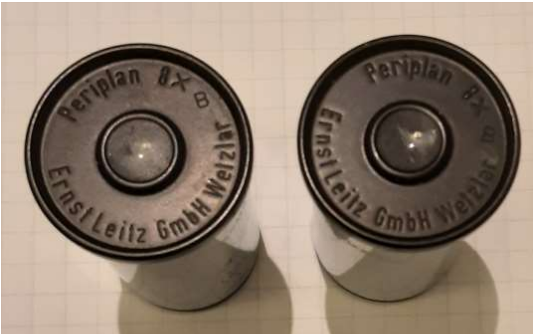
Beschriftung: Periplan 8 x B / Ernst Leitz GmbH Wetzlar Höhe 43mm / Durchmesser 23mm / Beschriftung am Mantel: GERMANY
