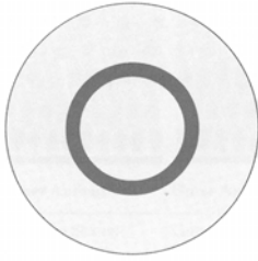
Phasenplatte (Phasenring) im Objektiv bei nicht eingeschalteter Ringblende.
