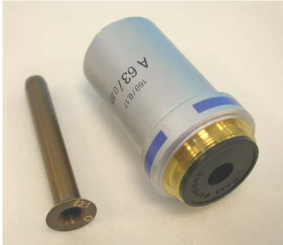
Objektiv 63:1 mit Dunkelfeld-Einsteckblende
