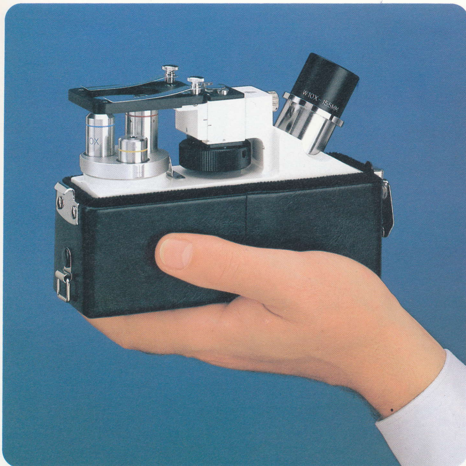
Exkursions-Mikroskop mit Pentax Auto 110, Kamera-Adapter, Batterie-Leuchte.
