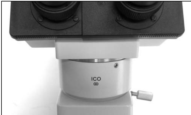
Abb. 22: Tubusoptik für Unendlich-Objektive mit binokularem Beobachtungstubus H.
