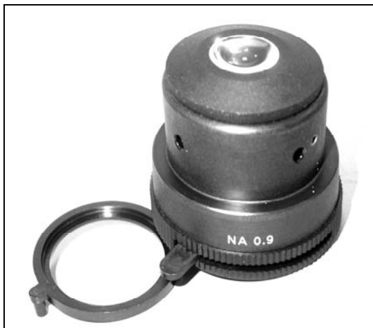
Abb. 10: Kondensor NA 0,9 mit ausgeklapptem Filterhalter und Hebel zur Einstellung der Aperturblende in Stellung „voll geöffnet“.
