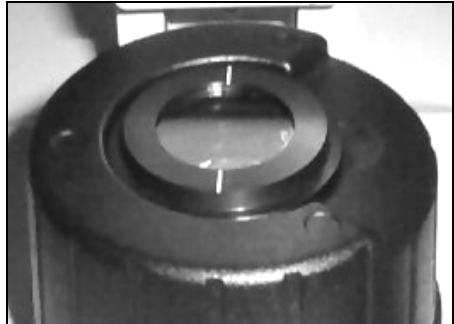
Abb. 45: Polarisator der WP II auf Beleuchtungsstutzen.
