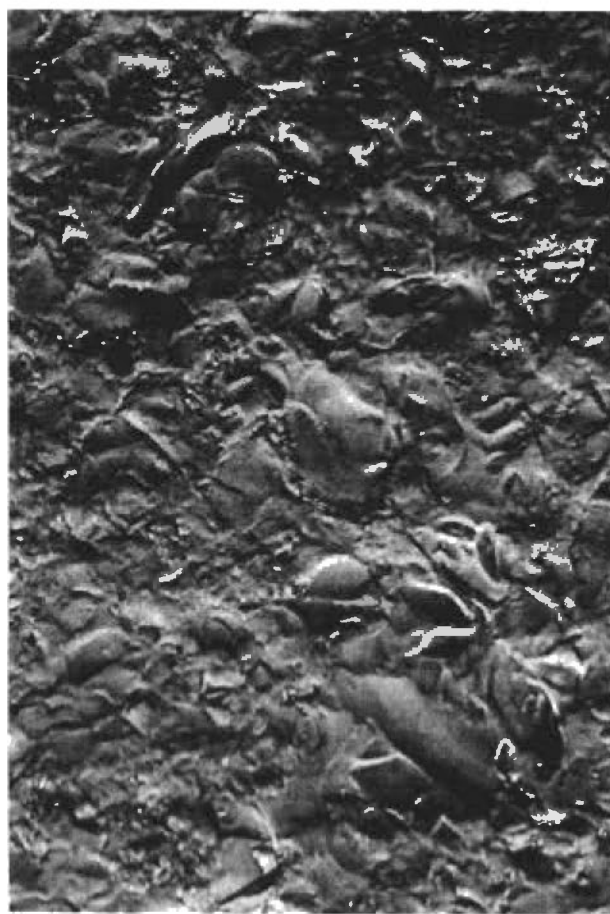
Abb. 2: Oberfläche einer mit der Schleifscheibe aufgerauten Mattscheibe. Planachromat 40×/0,65; Projektiv 4×. Interferenzkontrast.
