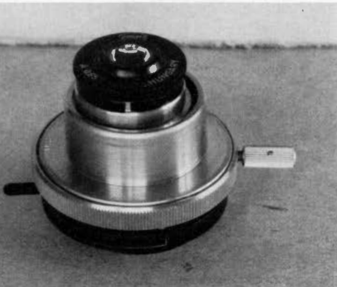
Bild 1: „3D“-Kondensor. Blick auf die Frontlinse mit Abdeckung. Links der Hebel für die Irisblende, rechts die Zentrierschraube.
