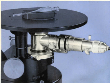
ULTROPAK mit Beleuchtungsansatz 8 V 5 W für Auflichtbeobachtungen. Mit dem ULTROPAK lassen sich auch geeigneten Präparaten auch höhere Vergrößerungen als die für Durchlicht vorgesehenen erzielen.
