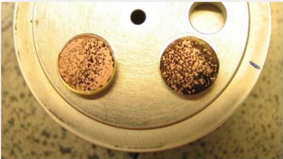
Ziel erreicht: hier mit Gold besputterte Proben, fertig zum Einbau ins Raster-EM
