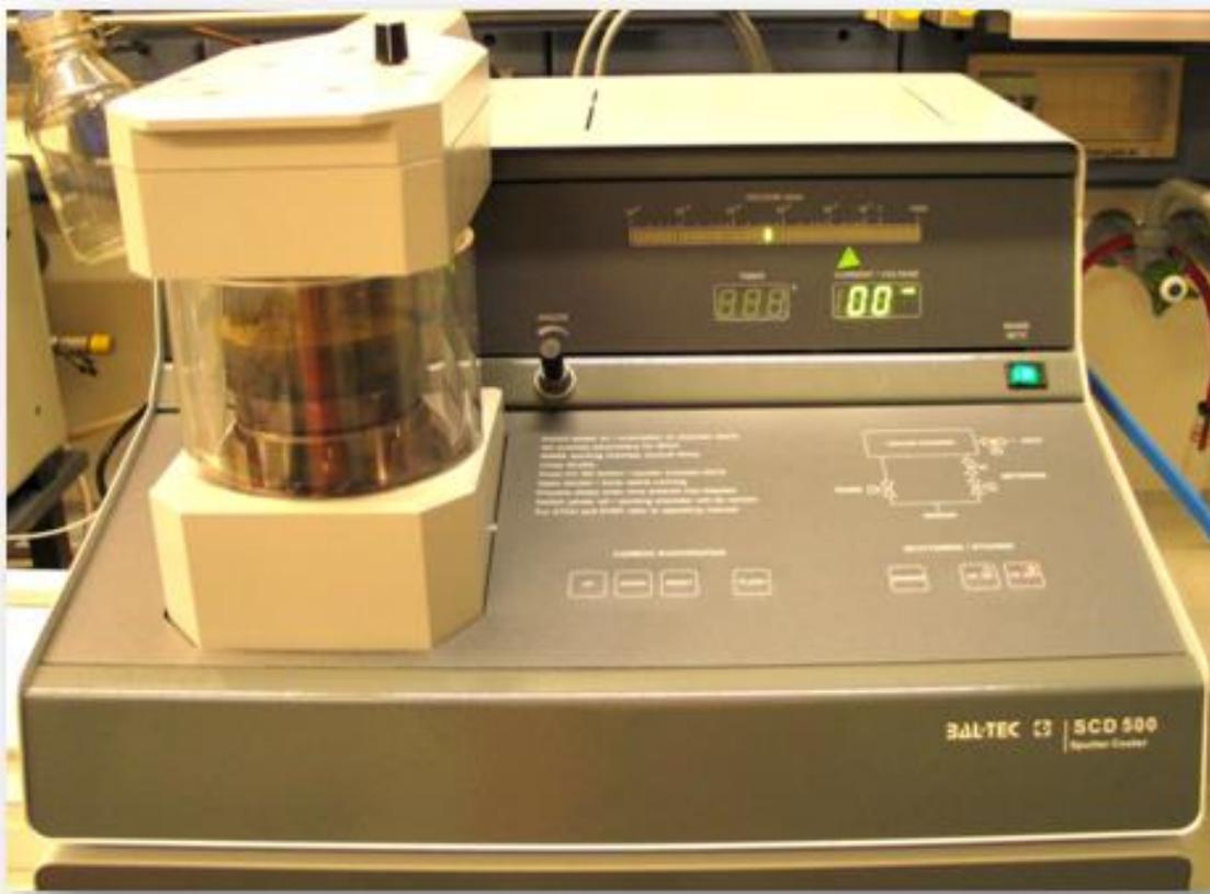
Kathodenerstäubungsanlage oder Sputteranlage
