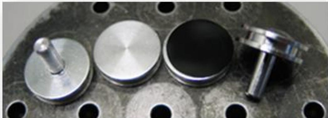
Zeiss Träger mit Kohleklebefilm, auf den die Deckgläser aufgeklebt werden
