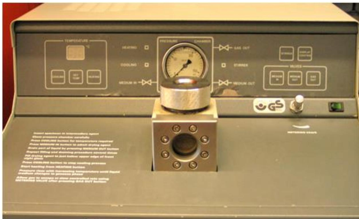
Kritischer-Punkt Trocknungsapparat, über Medium in und Medium out wird das Einströmen von flüssigem Kohlendioxid und Ausströmen von Aceton geregelt.
