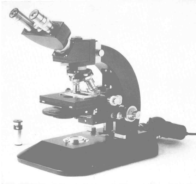
Abb. 18. Großes Forschungsmikroskop REICHERT „Zetopan“ mit Anoptraleinrichtung
