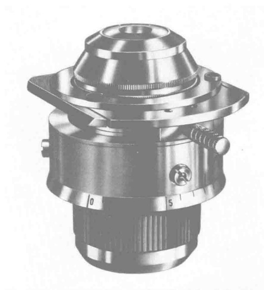
Abb. 19. REICHERT-Universalkondensor „Polyphos“ für Hellfeld, Dunkelfeld und Phasen- oder Anoptralkontrast, der mittels Schieber auf das „Zetopan“, Abb. 18, aufgesetzt werden kann
