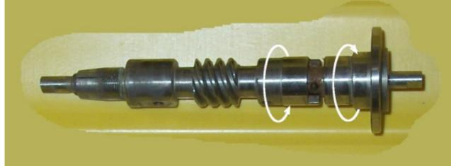
Nach dem Einlegen in Waschbenzin waren die beiden Teile wieder verdrehbar. Ich habe sie mit Ballistol geölt.
