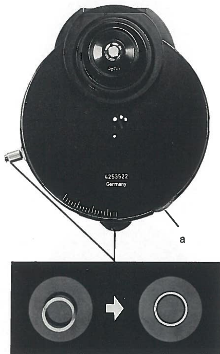
19 Phasenkontrastkondensor: Justierknöpfe für Ringblendenzentrierung, a = Irisblende für Hellfeldstellung J
