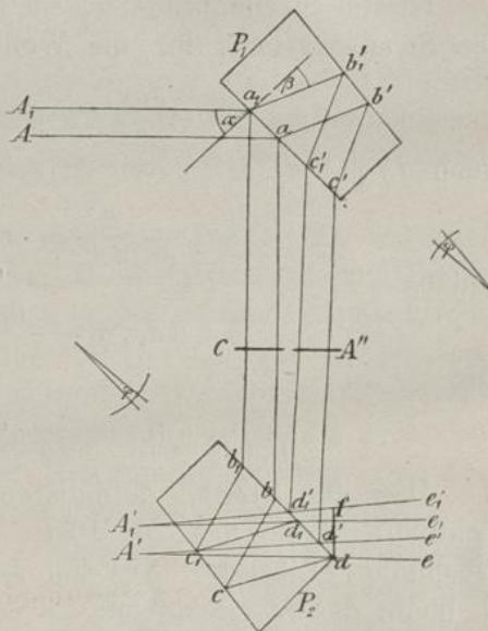
nehmen, dies sei für den Strahl  $Aa$  der Fall. Der Strahl  $A_1 a_1$  sei der erste dem Centralstrahl  $Aa$  benachbarte, für den für eine bestimmte Wellenlänge  $\lambda$  die Phasendifferenz gleich  $\lambda/2$  ist. Dann ist für ihn:
