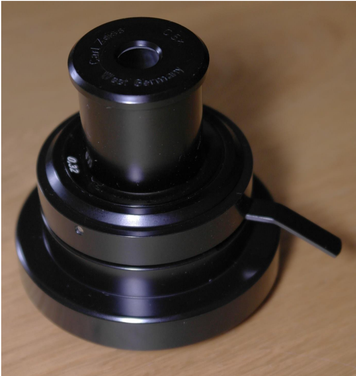
Abb. 3: Die Aufgesetzte Frontlinse beispielhaft an einem achromatisch-aplanatischen Hellfeldkondensor, sog. Pathologenkondensor, der den gleichen Aufbau hat wie die Revolverkondensoren dieser Reihe.
