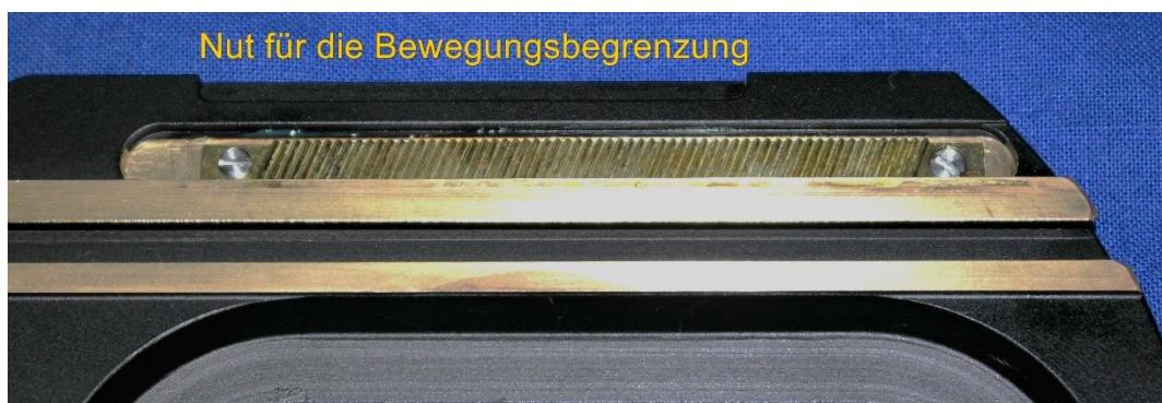
Zum Schluss wird noch das Seitenteil ohne Trieb und Skalierung angebracht. Auch dieses besitzt Passstifte, es wird mit drei schwarz lackierten Zylinderkopf-Schlitzschrauben befestigt.
