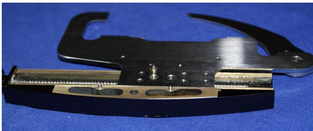
In die zwei größeren Gewindebohrungen kommen noch die Messingschrauben, in die jeweils eine kleine Feder eingesetzt wird. Links im Bild sieht man eine der Schrauben auf dem Kopf stehend, die Feder ist in sie verbracht. Die andere, rechts im Bild, ist bereits eingedreht. Die Federn drücken die Plastikhaube im Mitnehmer gegen die Triebsschnecke. Die Schrauben werden nicht bis zum Anschlag eingedreht, sondern ca. eine Umdrehung weniger, denn der Anpressdruck sollte nur von den Federn kommen.
