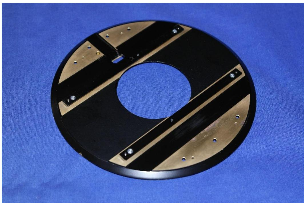
Die Tischplatte und das skalenfreie Seitenstück wurden ebenfalls mit schwarzer Folie verschönert. Das Seitenteil mit der Millimeterskala für die Y-Richtung wurde mit Monitorfolie geschützt. Im Bereich des zugehörigen Nonius auf der Tischplatte wurde die schwarze Folie rechtwinklig ausgeschnitten.
