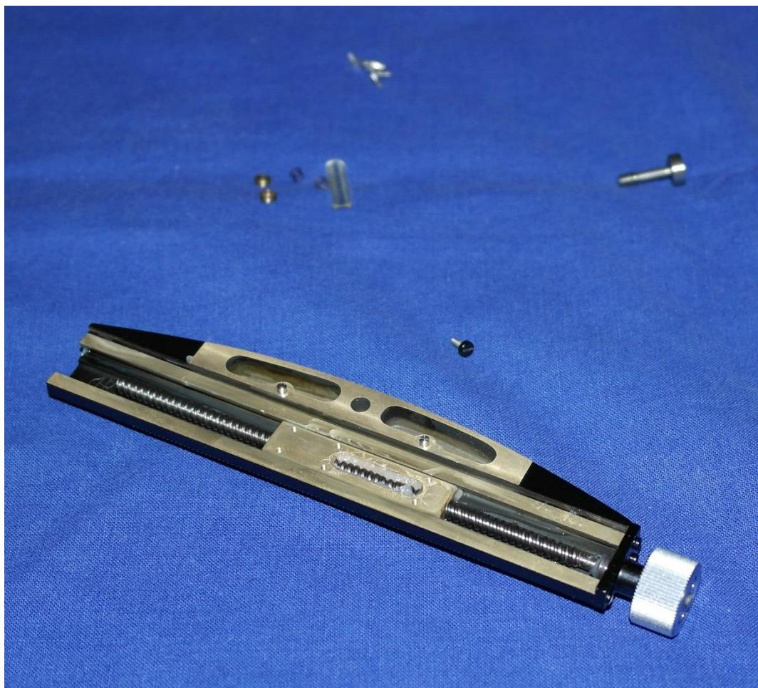
Eindrehen der Anschlagschraube am freien Ende der Triebsschnecke, sie hat ein **Linksgewinde**! Die Kunststoffplatte ist im Fenster des Mitnehmers eingesetzt.
