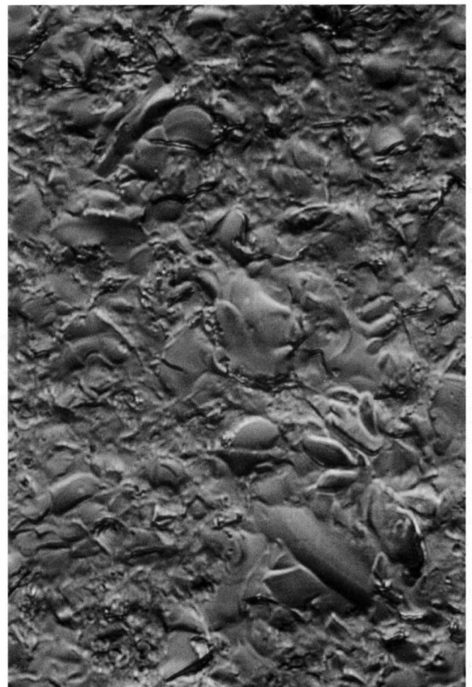
Abb. 2: Oberfläche einer mit der Schleifscheibe aufgerauten Mattscheibe. Planachromat 40×/0,65; Projektiv 4×. Interferenzkontrast.
