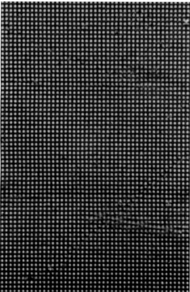
Abb. 3: Spektralfolie im Durchlicht. Planachromat 40×/0,65; Projektiv 4×. Interferenzkontrast.
