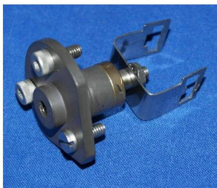
Jetzt kann man bequem die Spiegelhalterung samt ihrer Zentrierung entfernen. Beides wird ja bei LED-Betrieb nicht mehr benötigt.
