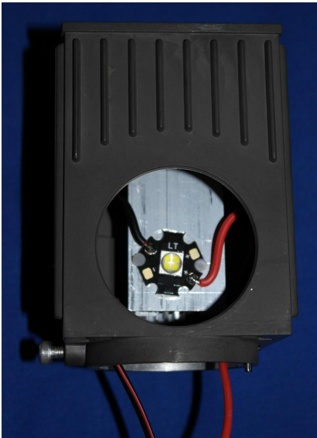
Deutlich ist zu erkennen, dass die LED asymmetrisch montiert ist. Das liegt daran, dass der Kühlkörper nur seitlich versetzt eingesetzt werden kann, da für die Achse der seitlichen Verstellung eine Einbuchtung in das Innere des Gehäuses ragt.
