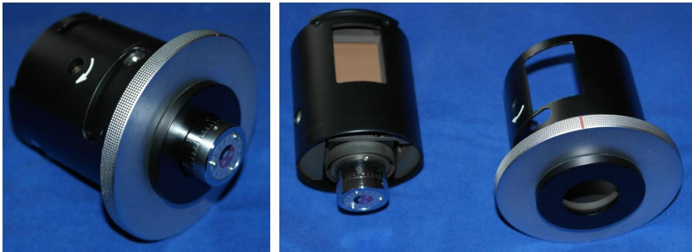
Die LED-Steuerung habe ich in eine Photokassette eingebaut. Das geht am einfachsten, wenn man eine Kassette mit Bildzählwerk dafür nimmt. Man braucht nur das äußere Teil. Die Öffnung für das Zählwerk kann man für das Poti nutzen; dann sollte es eines mit Ein-Ausschalt-Funktion sein.
