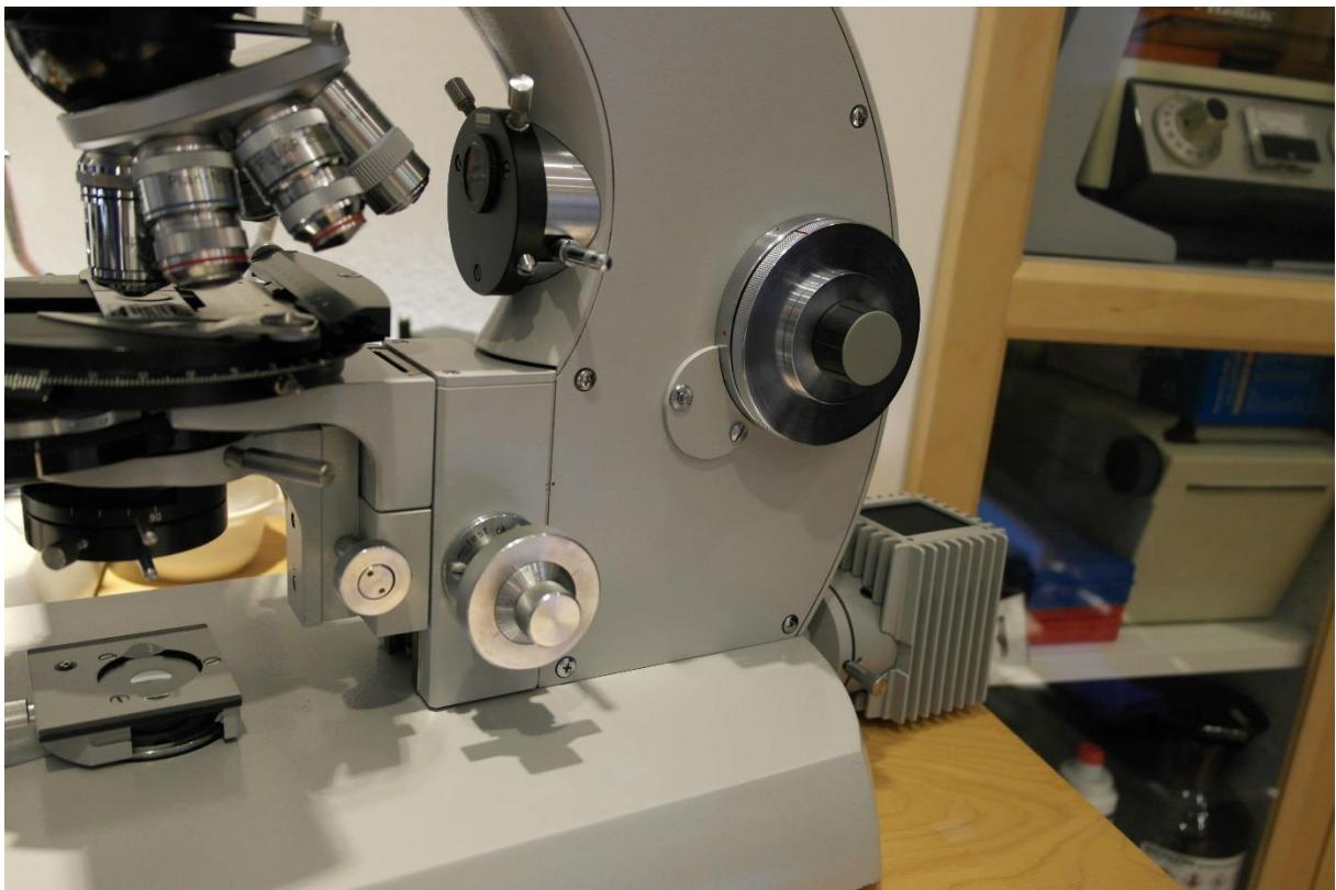
Die vorhandenen Kabelklemmtüllen habe ich mit DC-Buchsen bestückt, die größere für die Stromzufuhr, die kleinere für den Ausgang zur Lampe.
