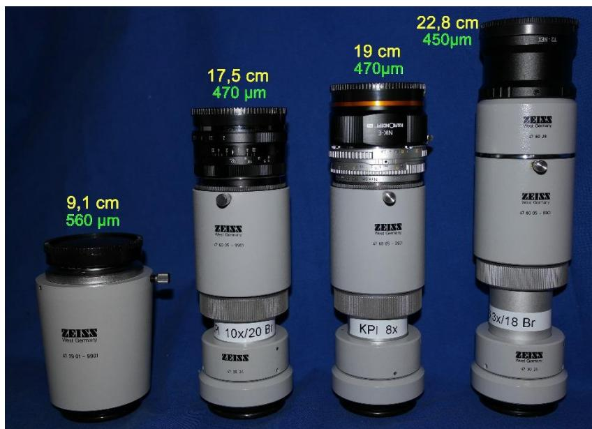
Bauhöhe von Auflage der unteren Schwalbe am Mikroskop bis zur Auflage am Kamerabajonett an, grün die Objektlänge der breiten Seite eines Bildes im 16:9-Format
