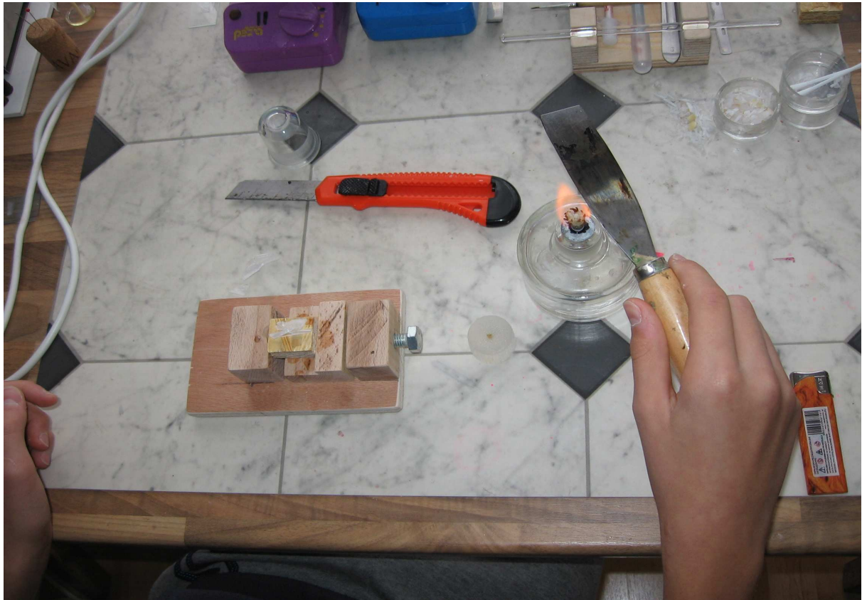
Abbildung 5: Schraubstock mit eingespanntem Holzklötz und aufgelegten Seifenschnipseln
