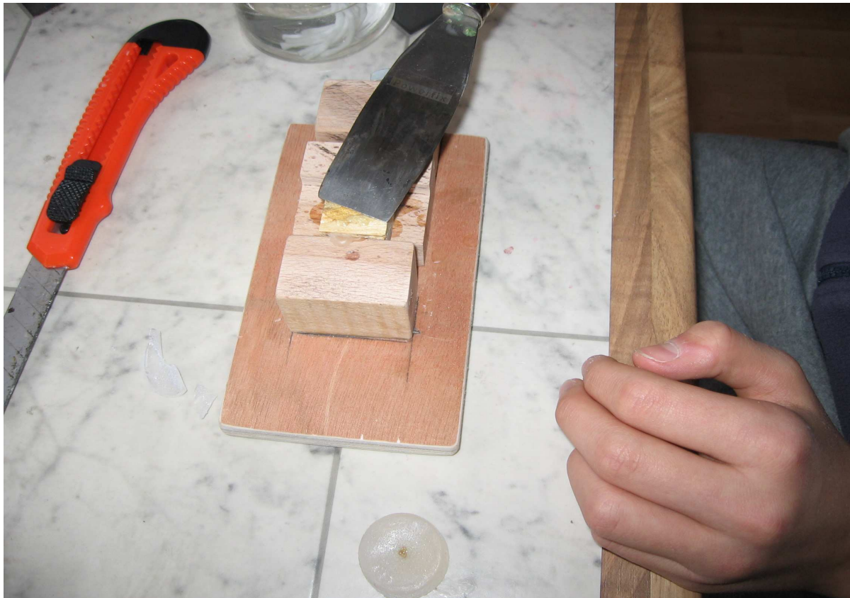
Abbildung 6: Schmelzen der Seifenschnipsel mit heißer Spachtel
