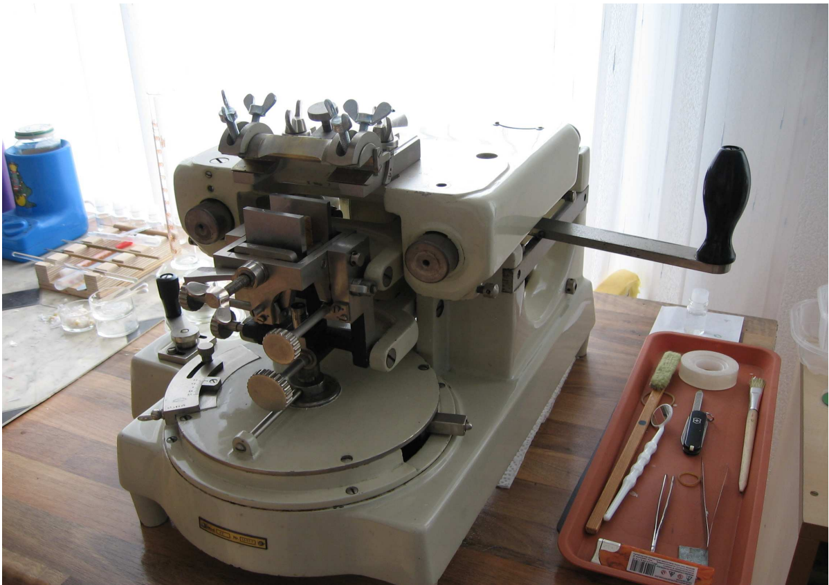
Abbildung 10: Sartorius Doppelzylinder Mikrotom Nr.32
