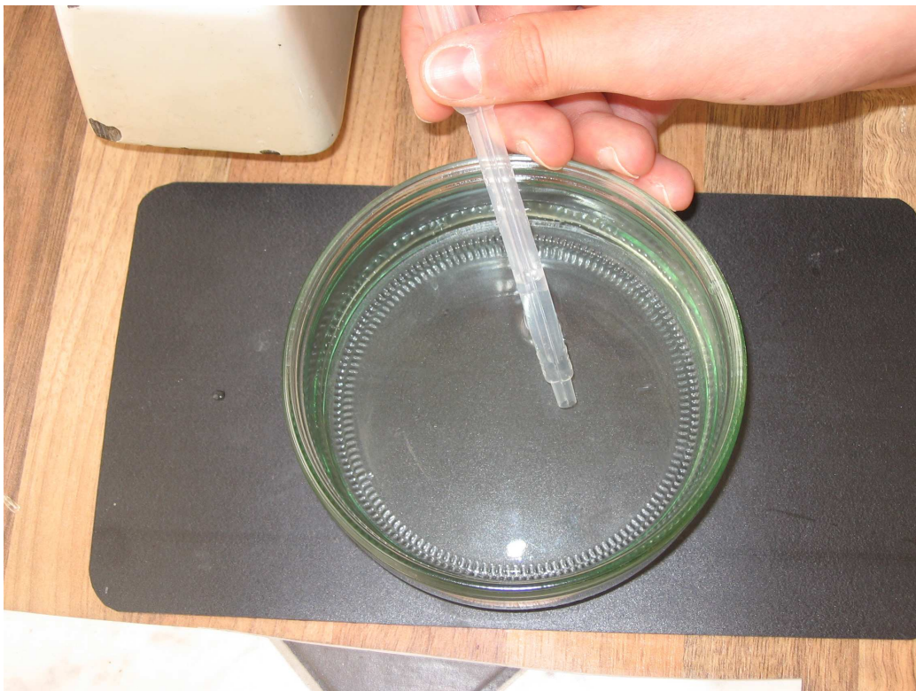
Abbildung 13: Absaugen der Schnitte mit abgeschnittener Pipette
