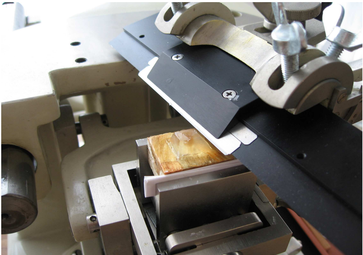
Abbildung 11: Eingespannter Block und schräg eingespanntes Messer
