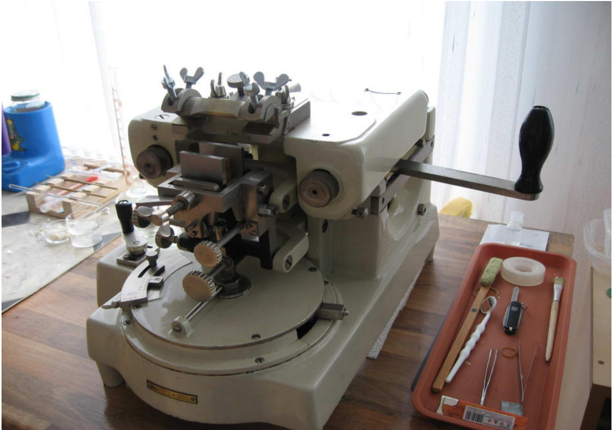
Abbildung 10: Sartorius Doppelzylinder Mikrotom Nr.32
