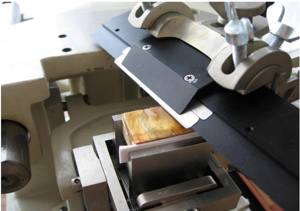
Abbildung 11: Eingespannter Block und schräg eingespanntes Messer
