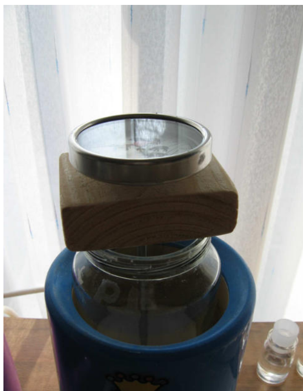
Abbildung 3: Babyflaschenwärmer mit Bratenthermometer
