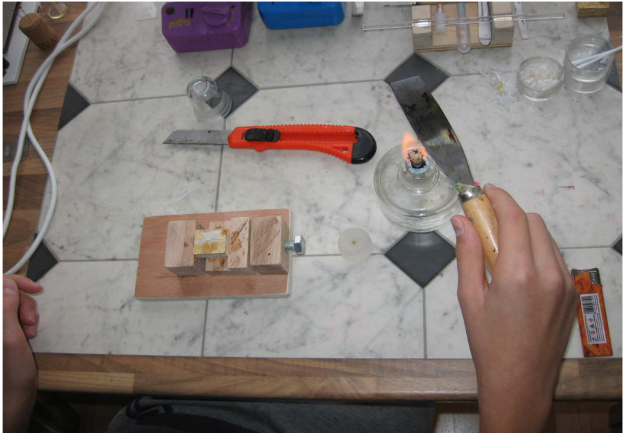
Abbildung 5: Schraubstock mit eingespanntem Holzklötz und aufgelegten Seifenschnipseln
