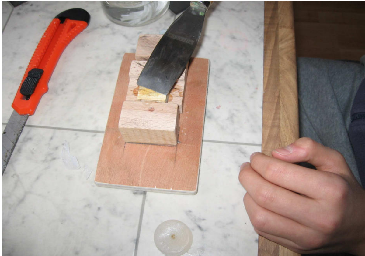
Abbildung 6: Schmelzen der Seifenschnipsel mit heißer Spachtel
