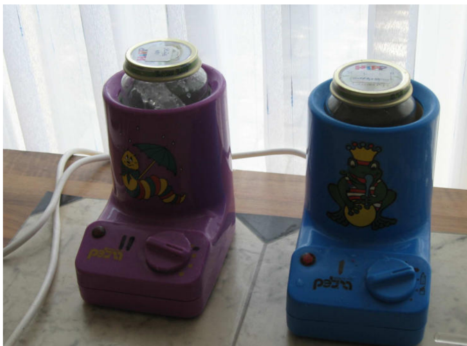
Abbildung 2: 2 Babyflaschenwärmer für Infiltrationsstufe 1 und 2
