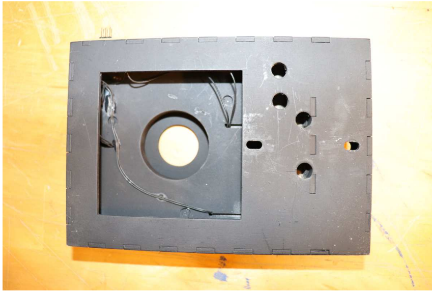
Bild 6 : Piezobühne ( erster Prototyp ) von Oben, zerlegt. Auf der rechten Seite ist das Unterteil und auf der linken das Oberteil. Man erkennt drei Piezoscheiben auf welchen das Oberteil ruht. Zusammengehalten wird alles durch Magnete welche im Ober und Unterteil verbaut sind.
