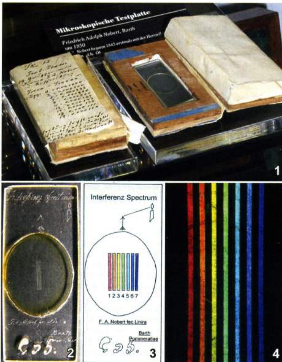
Abb. 1–4: Nobert'sche Probeplatte aus dem Optischen Museum der Ernst-Abbe-Stiftung Jena. Die Nobert'sche Interferenz-Spektrumplatte (Abb. 1), Ansicht der Linienblöcke im bildumkehrenden Mikroskop (Abb. 2) und in der schematischen Zeichnung (Abb. 3). Die sieben Linienblöcke in ihren Spektralfarben im Dunkelfeld, Zeiss-Objektiv S 10/0,25 Iris, Okular 5x (Abb. 4).
